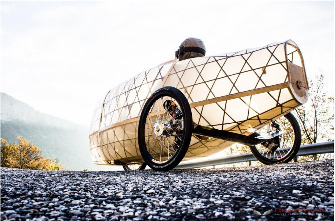
Figure 1: exemple de carénage d'un des Mosquitos artisanaux originaux
